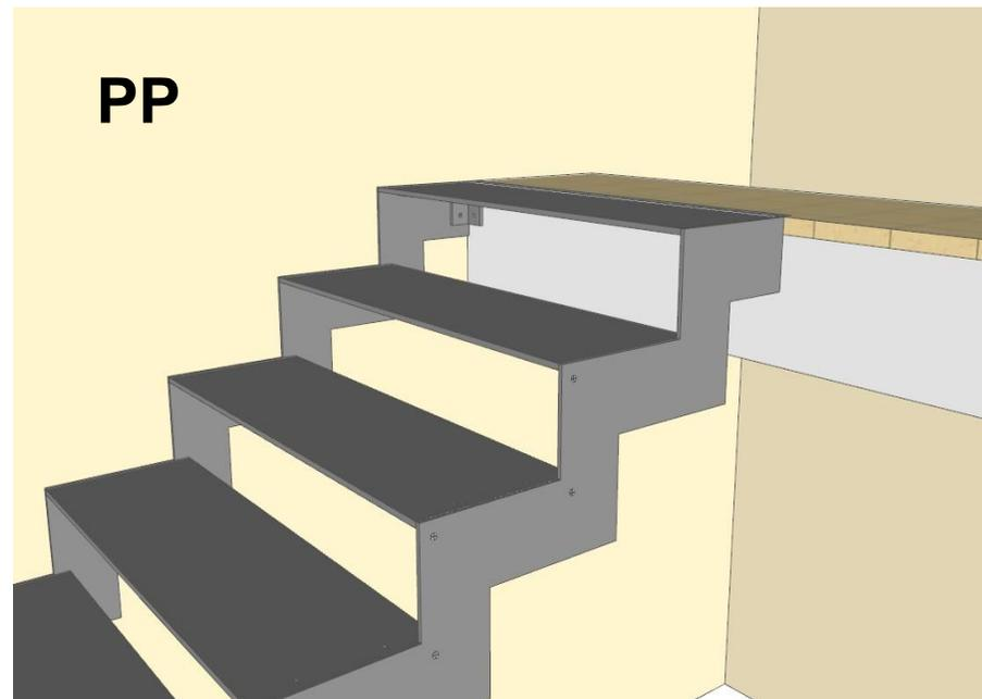
上階フロアと同レベルにて最上段ステップを設定
