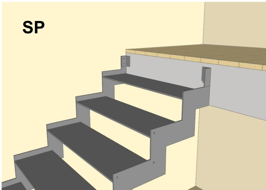
上階フロアで上がり切る形で最上段ステップを設定
