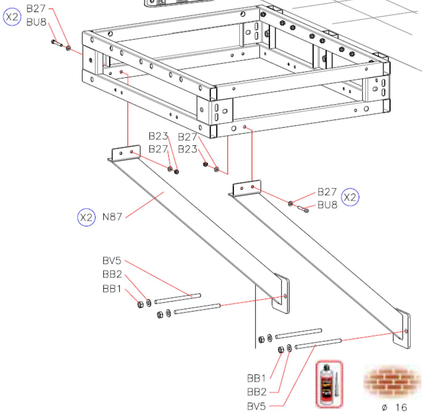
【C:踊場用支柱が階段固定の壁と違う方向の場合】
